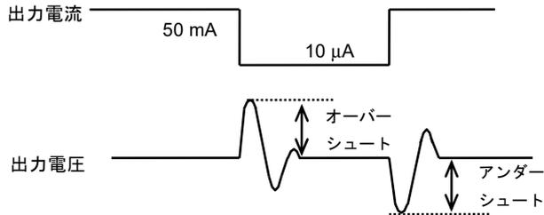
図17 出力電流による出力電圧の変動
