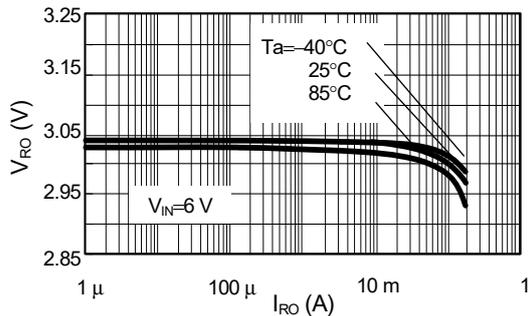
1.6 出力電流 ( $I_{OUT}$ ) - 出力電圧 ( $V_{OUT}$ ) 特性
