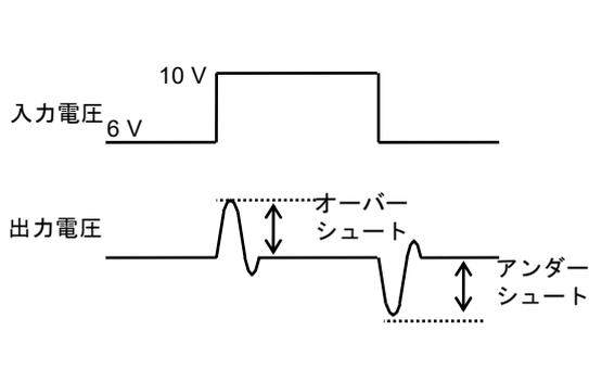
図13 電源変動：6 V↔10 Vの矩形波の場合
