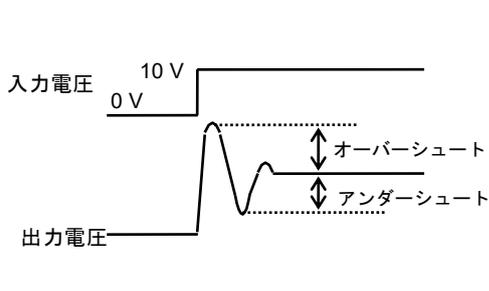
図9 電源投入：0 V→10 Vの矩形波の場合
