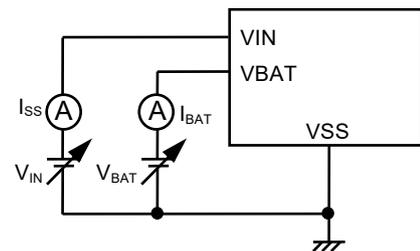
$I_{BAT2}$ 測定時には、 $V_{IN}$ に6 V印加後、 $V_{IN}$ をオープンにして、 $I_{BAT}$ を測定する。
