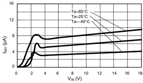
4.2  $V_{BAT}$ — $V_{BAT2}$ 消費電流 ( $I_{BAT2}$ ) 特性
