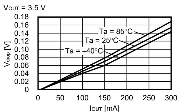
(4) ドロップアウト電圧－設定出力電圧
