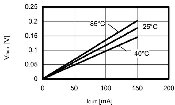
(4) ドロップアウト電圧—設定出力電圧
