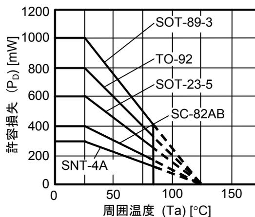
図8 パッケージ許容損失 (基板実装時)
