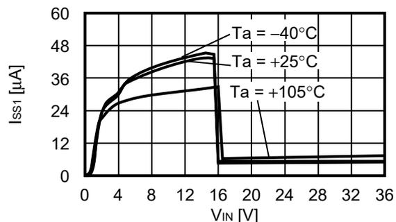
8. 動作時消費電流 – 動作周囲温度
