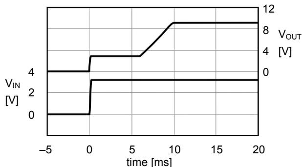
4.2 パワーオフ端子応答 ( $V_{OUT} = 9.2\text{ V}$ ,  $V_{ON/OFF} = 0\text{ V} \rightarrow 3.3\text{ V}$ )
