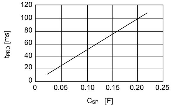
図 14 C<sub>SP</sub> vs. t<sub>PRO</sub>
