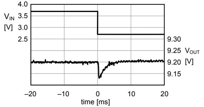
(3)  $f_{OSC} = 700\text{ kHz}$ ,  $V_{IN} = 2.7\text{ V} \rightarrow 3.7\text{ V}$
