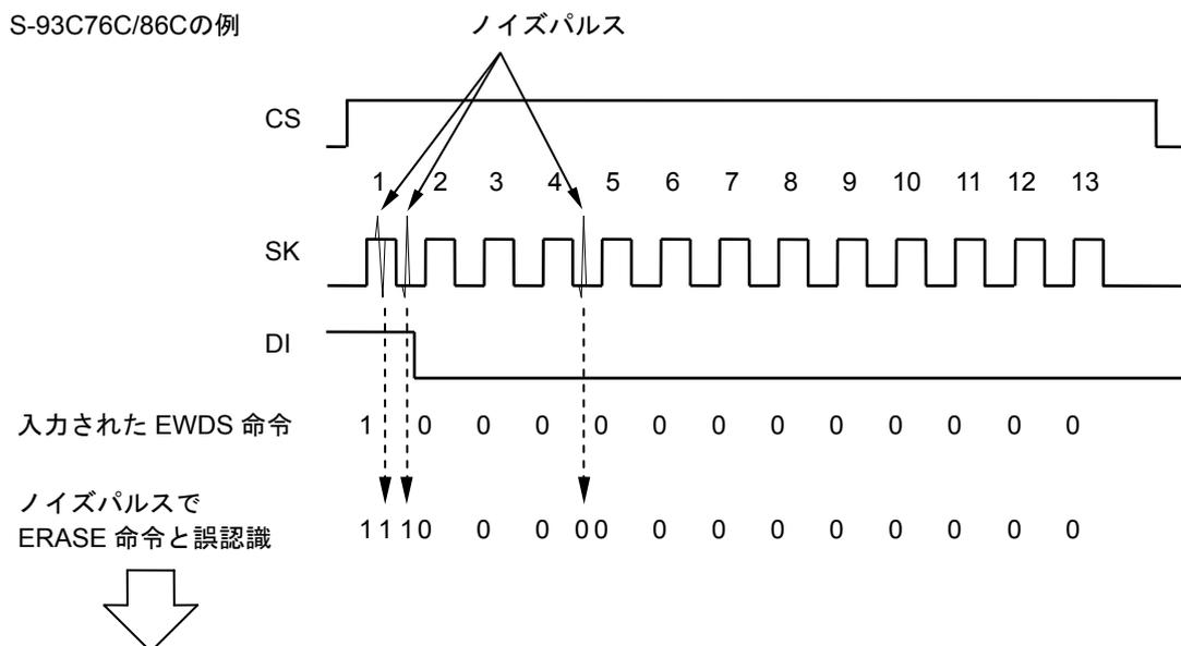
クロックパルスモニタ回路が内蔵されていない製品ではアドレス00hに "FFFFh" が誤書き込みされますが、S-93C76C/86Cでは、オーバーカウント判定され、書き込み動作は行われず命令がキャンセルされます。
