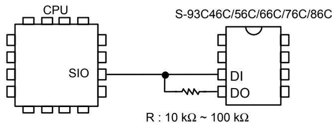
図22 3線式インタフェースの接続法
