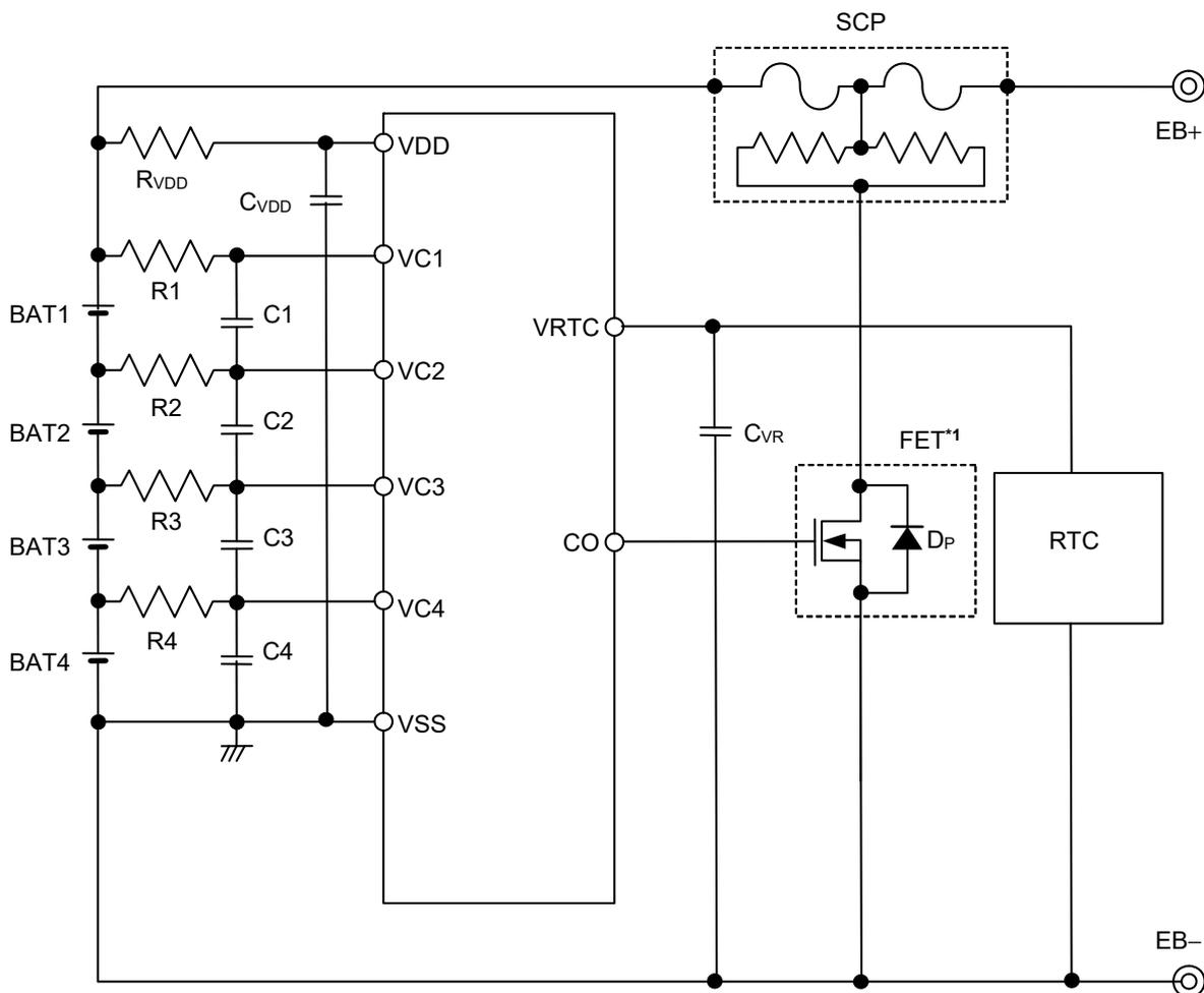
\*1. 本ICはCO端子出力電圧を7.5 V max.に制限するため、ゲート耐圧8 VのFETの使用が可能です。
