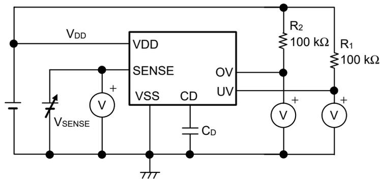
図14 検出電圧、解除電圧の測定回路
