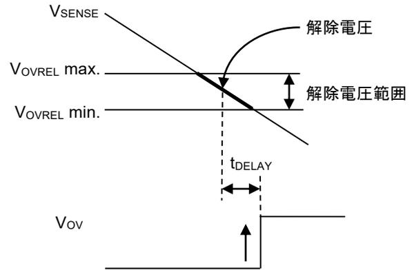
図11 過電圧解除電圧
