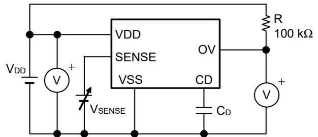
図35 検出応答時間の測定回路 (過電圧検出)
