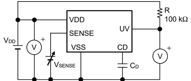
図33 検出応答時間の測定回路 (低電圧検出)
