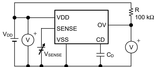
図39 解除遅延時間の測定回路 (過電圧検出)
