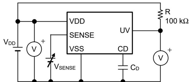
図37 解除遅延時間の測定回路 (低電圧検出)
