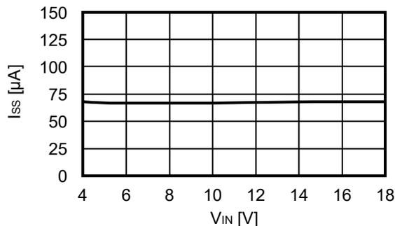
1.2 パワーオフ時消費電流 (I<sub>SSS</sub>) – 入力電圧 (V<sub>IN</sub>)
