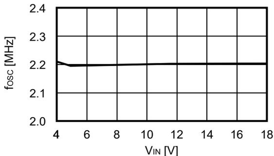
1.5 発振周波数変動率 (F<sub>SSS</sub>) – 入力電圧 (V<sub>IN</sub>)
