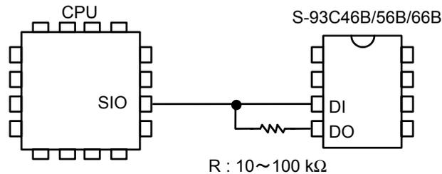
図20 3線式インタフェースの接続法
