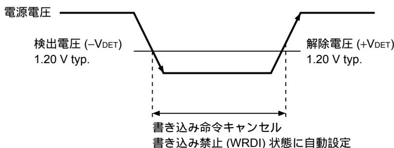
図 19 低電源電圧時の動作
