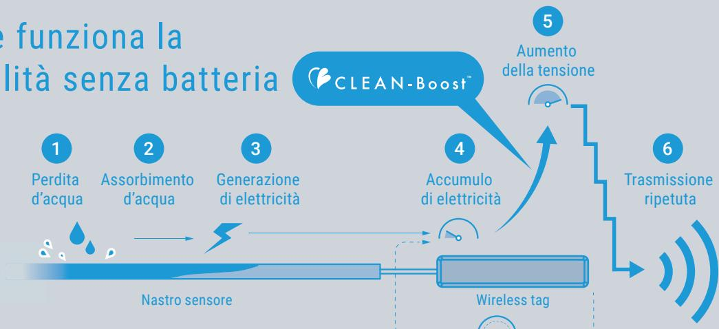
L'acqua assorbita dal nastro sensore e l'elettrodo metallico intessuto nel nastro sensore reagiscono generando una piccola quantità di elettricità. Il wireless tag sfrutta la tecnologia CLEAN-Boost™ per accumulare e amplificare piccole quantità di elettricità e azionare un modulo Bluetooth® Low Energy (BLE) che segnala perdite d'acqua mediante segnali wireless. Finché il nastro sensore è bagnato, continua ad accumulare, amplificare e trasmettere segnali.
