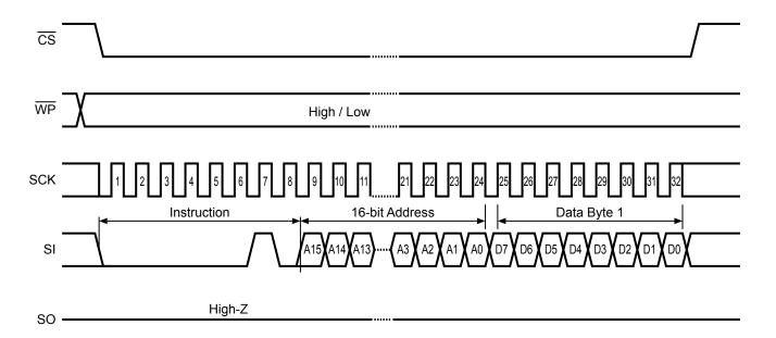
Figure 16 WRITE Operation (1 Byte)
