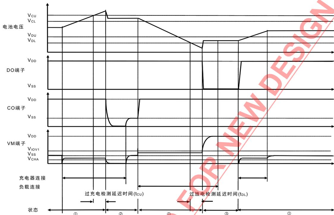
备注 ①：通常状态 ②：过充电状态 ③：过放电状态 ④：过电流状态
