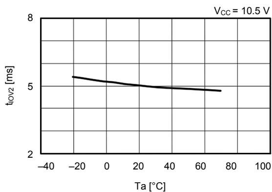
过电流3 (负载短路) 检测时间 温度依赖性
