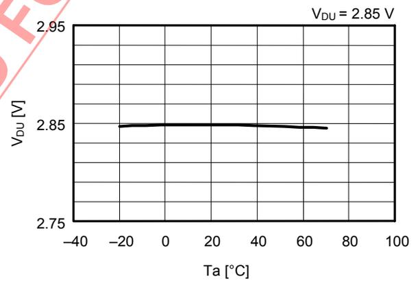
过电流1检测电压 温度依赖性
