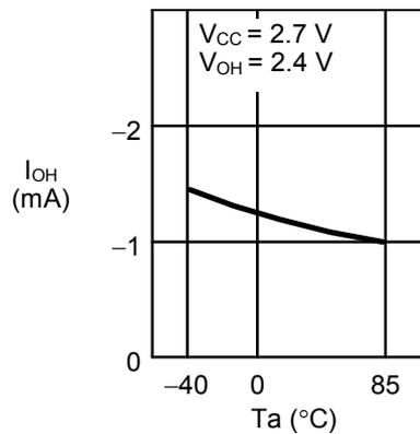
1.25 高电位输出电流 $I_{OH}$ —周围温度 $T_a$
