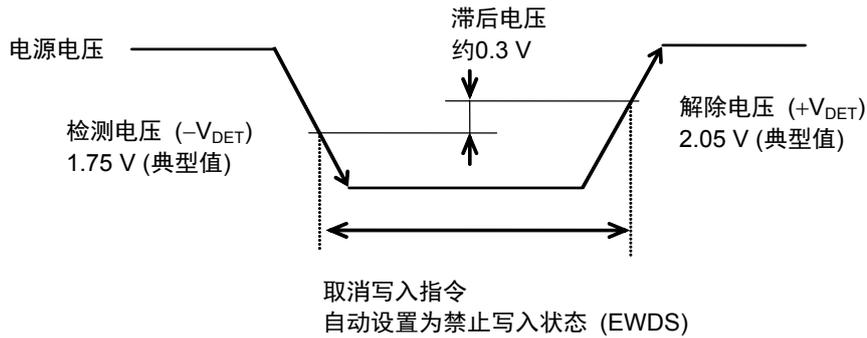
图12 低电源电压时的工作
