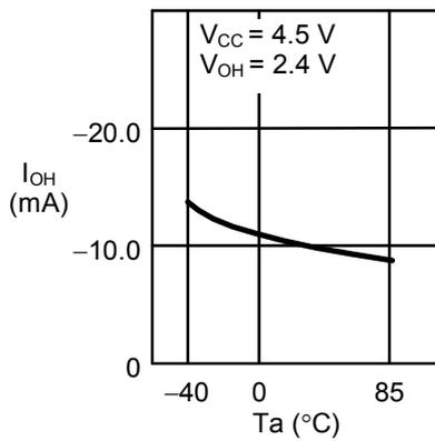
1. 24 高电位输出电流I<sub>OH</sub>—周围温度Ta
