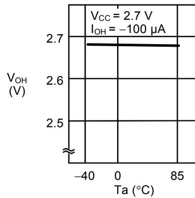
1. 19 高电位输出电压V<sub>OH</sub>—周围温度Ta
