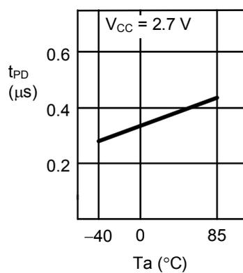
2.8 数据输出延迟时间 $t_{PD}$ —周围温度 $T_a$
