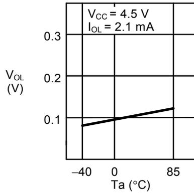
1. 22 低电位输出电压V<sub>OL</sub>—周围温度Ta
