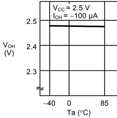
1. 20 高电位输出电压V<sub>OH</sub>—周围温度Ta
