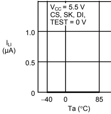
1.14 输入泄漏电流 $I_{LI}$ —周围温度 $T_a$
