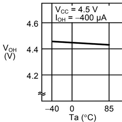
1.18 高电位输出电压 $V_{OH}$ —周围温度 $T_a$
