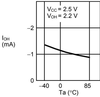
1.26 高电位输出电流 $I_{OH}$ —周围温度 $T_a$
