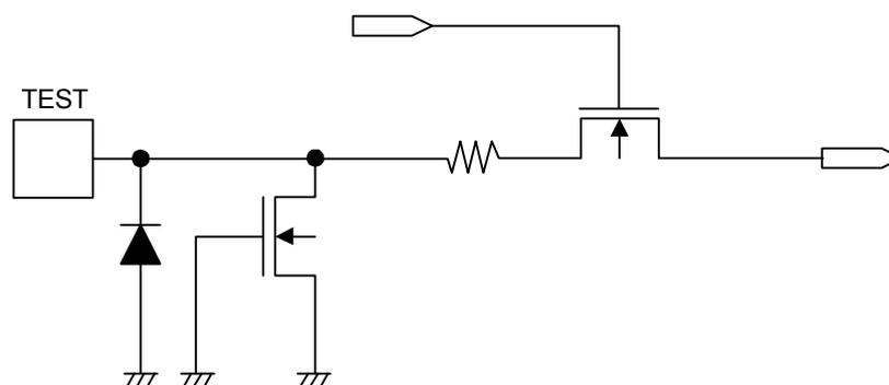
图16 TEST端子
