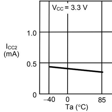
1.9 程序分析时消耗电流 $I_{CC2}$ —周围温度 $T_a$
