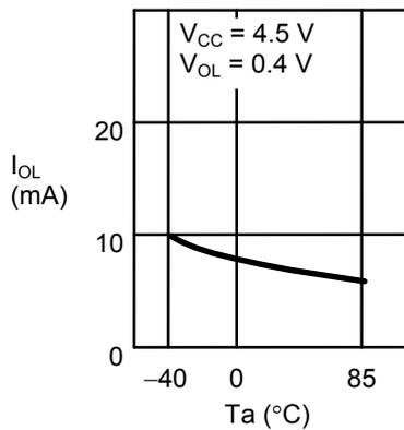
1.28 低电位输出电流 $I_{OL}$ —周围温度 $T_a$
