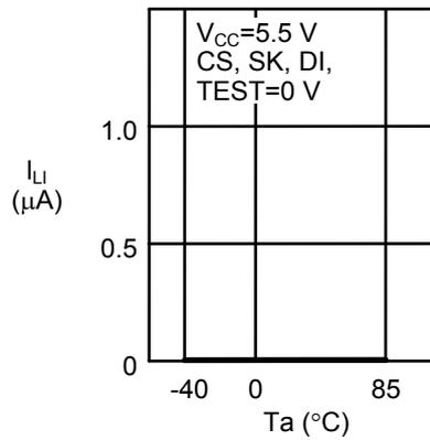
1.14 输入泄漏电流 $I_{LI}$ —周围温度 $T_a$
