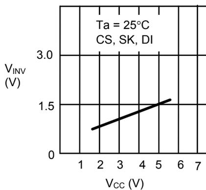
1.30 输入翻转电压 $V_{INV}$ —周围温度 $T_a$
