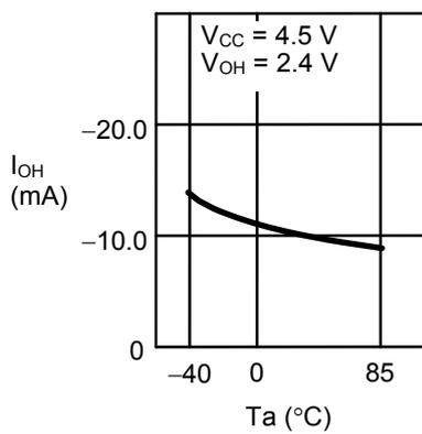
1. 24 高电位输出电流I<sub>OH</sub>—周围温度Ta
