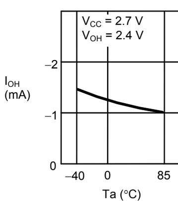
1.25 高电位输出电流 $I_{OH}$ —周围温度 $T_a$
