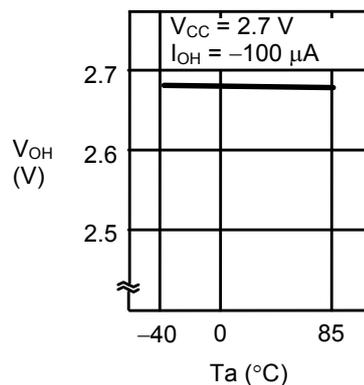
1. 19 高电位输出电压V<sub>OH</sub>—周围温度Ta
