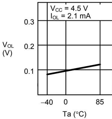
1. 22 低电位输出电压V<sub>OL</sub>—周围温度Ta
