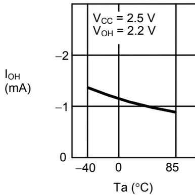
1.26 高电位输出电流 $I_{OH}$ —周围温度 $T_a$
