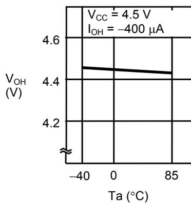
1.18 高电位输出电压 $V_{OH}$ —周围温度 $T_a$
