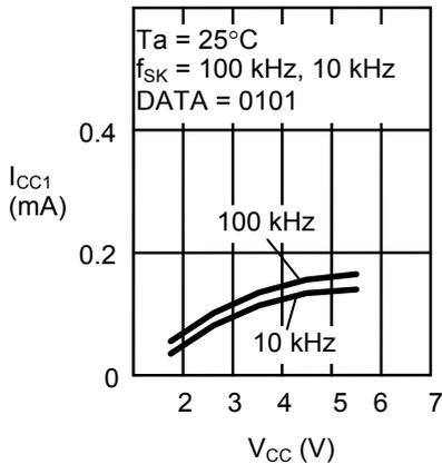
1.6 读出时消耗电流 $I_{CC1}$ —时钟频率 $f_{SK}$
