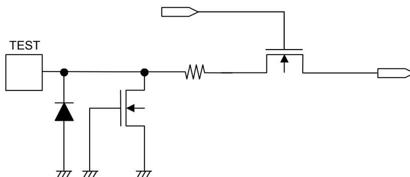
图25 TEST端子
