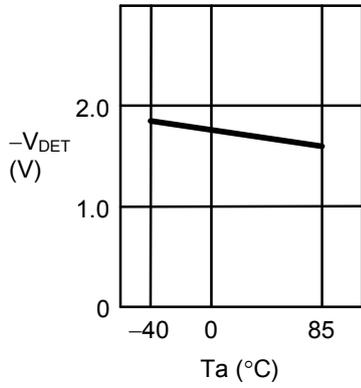
1.32 低电源解除电压 $+V_{DET}$ —周围温度 $T_a$
