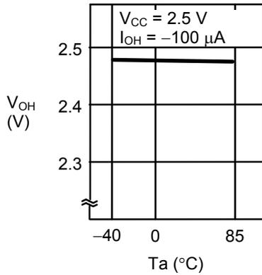
1. 20 高电位输出电压V<sub>OH</sub>—周围温度Ta
