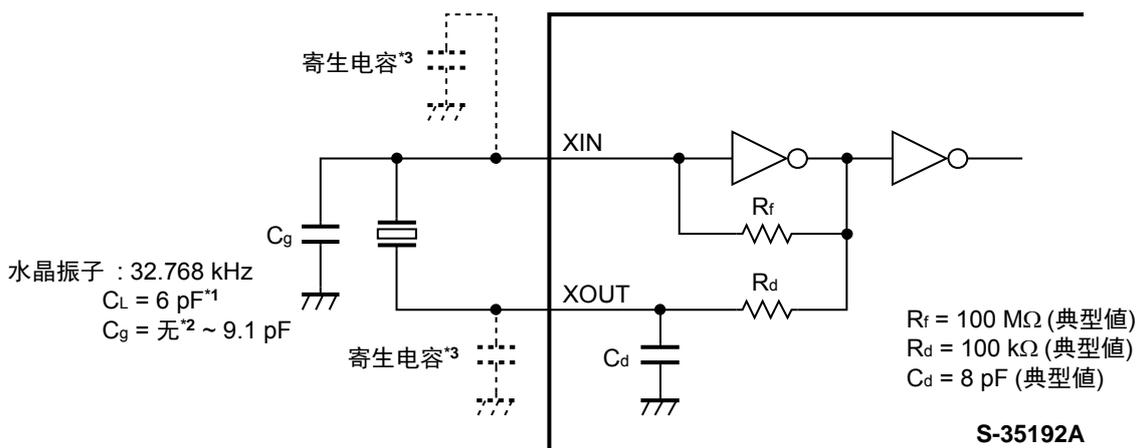
\*1. 使用 $C_L$ 值为7 pF的水晶振子时, 请根据需要外接 $C_d$ 并进行调整。
