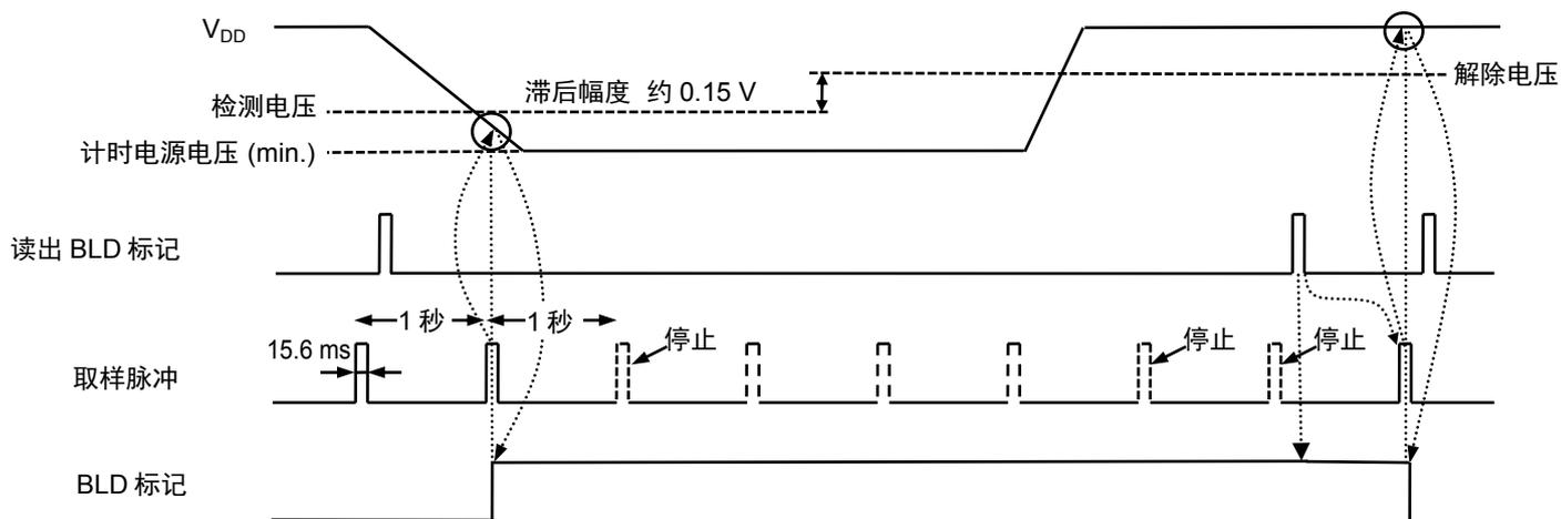
图21 低电源电压检测电路时序
