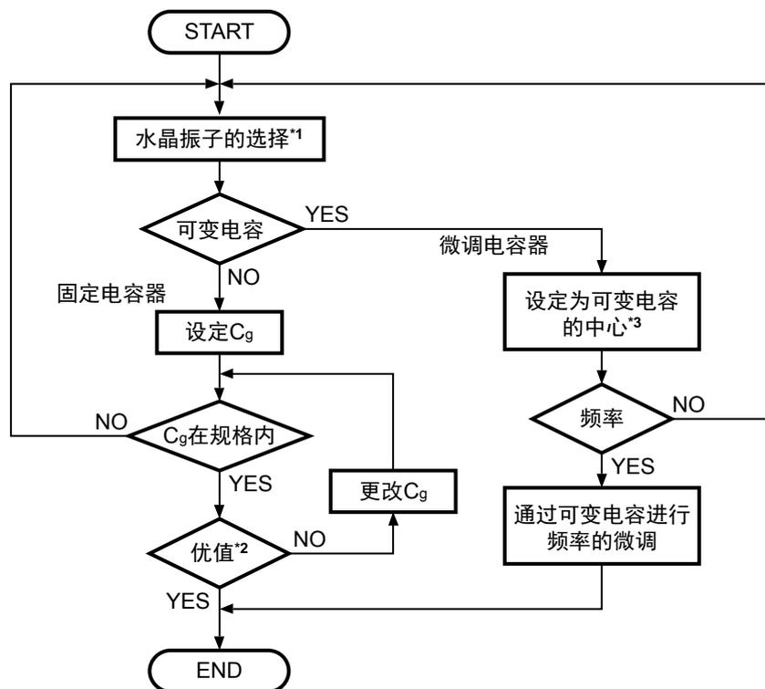
\*1. 请委托水晶振子生产厂家进行IC与水晶振子的匹配测试。推荐的石英特性值为 $C_L$ 值 (负载容量) = 6 pF、 $R_1$ 值 (等效串联电阻) = 50 k $\Omega$  (最大值)。
