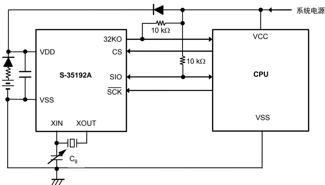
注意 请在接通系统电源并处于稳定状态后，再进行通信。
