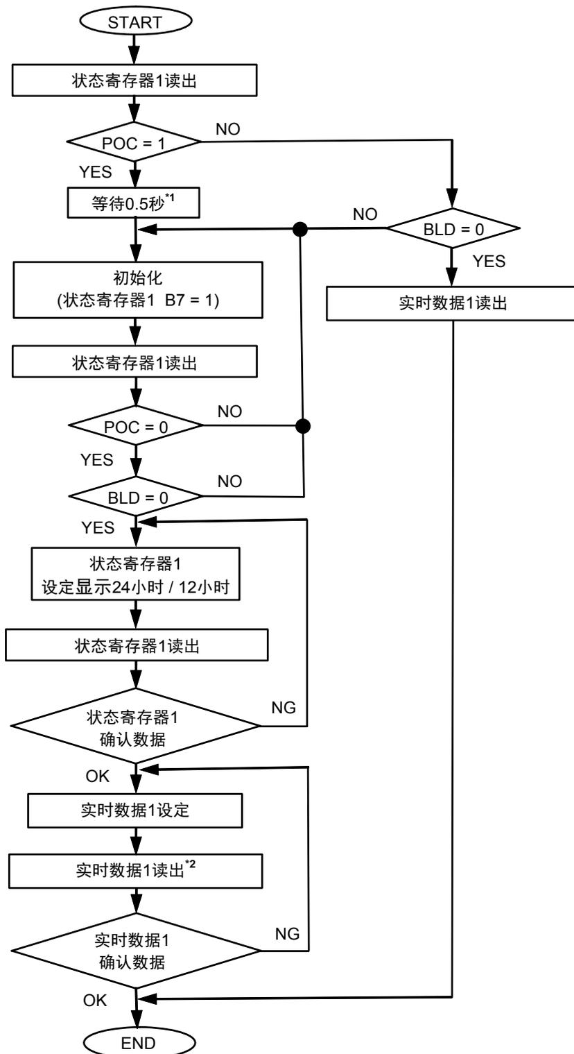
\*1. 因电源接通检测电路在工作中，请在0.5秒内不要进行通信。
