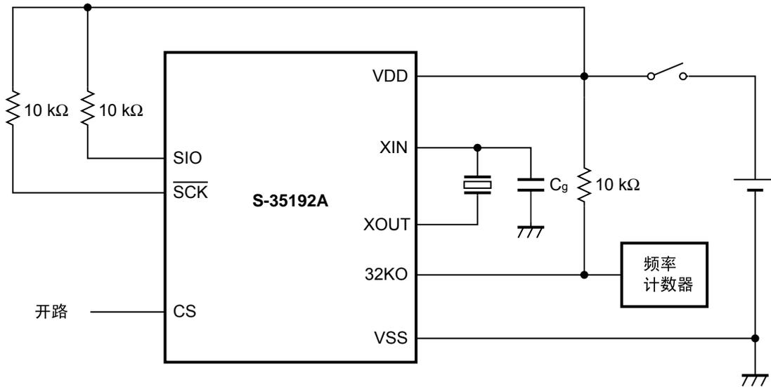
图37 振荡频率的测定电路构成
