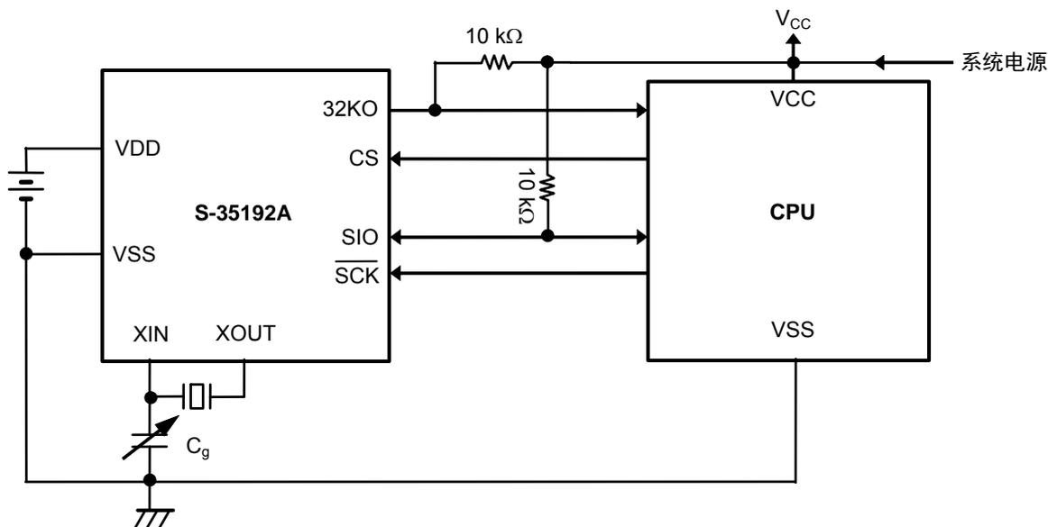
注意 1. 由于I/O端子处没有连接VDD端的保护二极管，所以可以在 $V_{CC} \geq V_{DD}$ 的条件下使用。但是，请务必遵守规格的要求。
