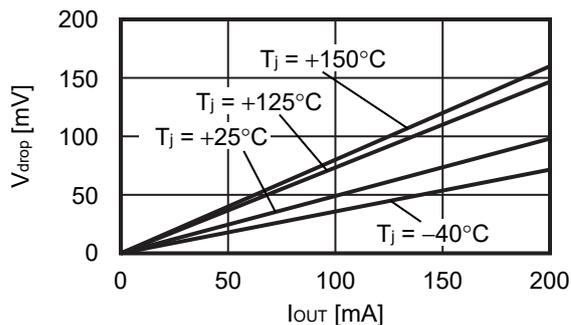
1.4 输入输出电压差 – 结点温度
