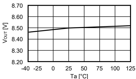
**2.15 唤醒电压 ( $V_{WAKEUP}$ ) – 温度 ( $T_a$ )**
