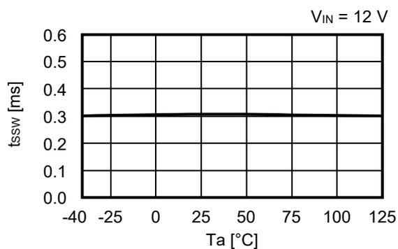
2.9 软启动时间 ( $t_{SS}$ ) – 温度 ( $T_a$ )
