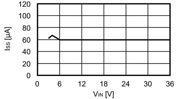
1.2 电源关闭时消耗电流 (Isss) – 输入电压 (VIN)
