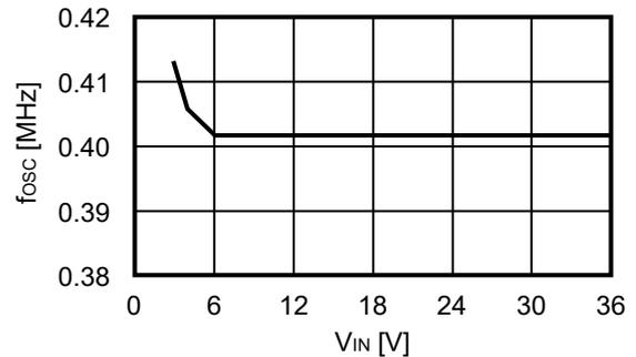
1.5 振荡频率变调率 (Fsss) – 输入电压 (VIN)
