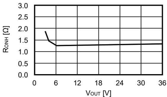
1.4 GATE端子导通电阻 (R<sub>ONL</sub>) – 输出电压 (V<sub>OUT</sub>)
