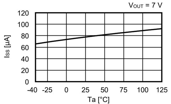
2.2 停止时消耗电流 (I<sub>SSS</sub>) - 温度 (Ta)
