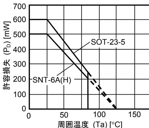
図4 パッケージ許容損失 (基板実装時)
