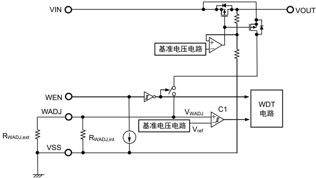
图38 输出电流检测电路的工作说明图
