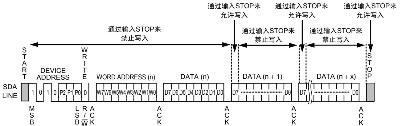
图30 通过在写入过程中输入停止状态来执行写入工作
